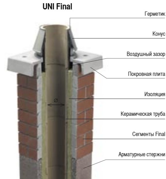
Комплект UNI Final для верхней части дымовой трубы
